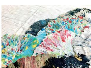
チップを200℃の熱で溶かし圧をかけて1枚のシート状に。溶けたプラスチックが混ざり合うことで独特の色合いになります。
