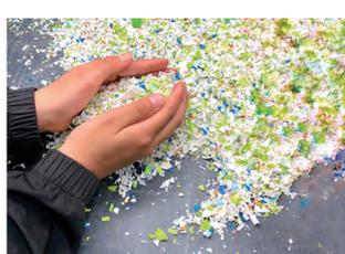
ビーチクリーンで回収した海洋プラスチックを専用の機械で粉碎してチップ状に。加工する前に洗浄してきれいにします。
